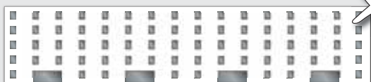
1 | Ungegliederte, einfache Lochfassade bei einem horizontal ausgerichteten Gebäude mit ca. 80,0 m Länge
